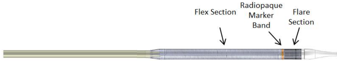
Imagen 4 Partes de la capsula y punta del Sistema de catéter de liberación para la Válvula aortica Transcateter Evolut Pro+
